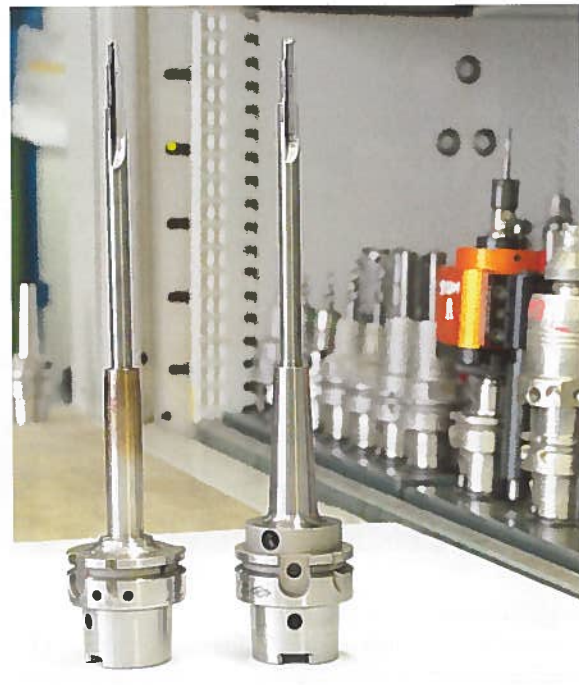
Links das zuvor eingesetzte Schrumpffutter und rechts das additiv gefertigte Hydrodehnspannfutter High Torque Chuck (HTC) mit seiner Verjüngung von drei Grad.
