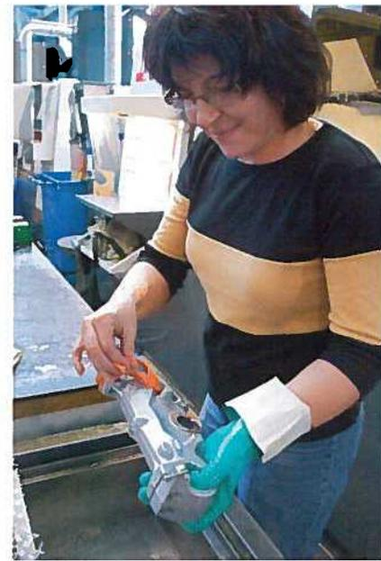
Um die perfekten Oberflächen zu schützen, müssen die Designteile vor der Bearbeitung abgeklebt werden (oben)
