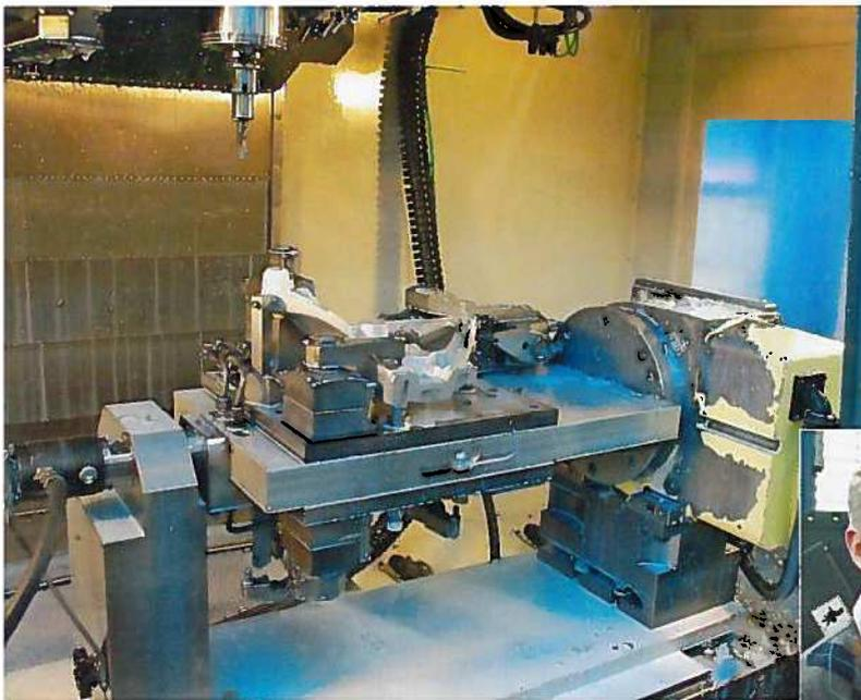
Fräsbearbeitung eines Motorradteils auf der VF-3SSYT
