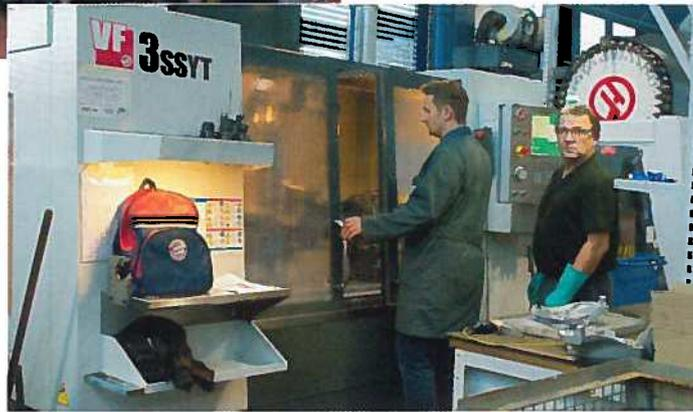
Das Vertikale Super-Speed-Bearbeitungszentrum VF-3SSYT von Haas bietet einen Werkzeug-Schnellwechsler mit 24+1 Magazinplätzen und Eilgänge bis 35,6 m/min (rechts)
