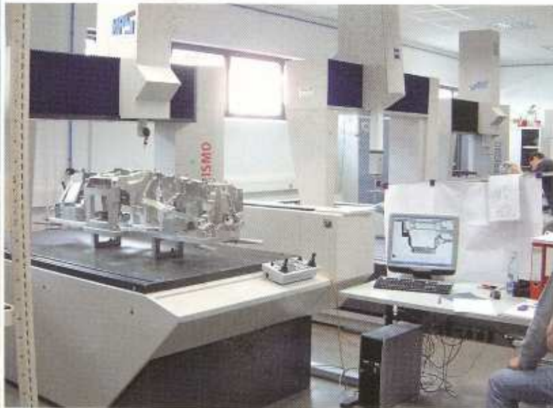
Qualität bewiesen: Zum Überwachen der Fertigung, Sichern und Dokumentieren der Qualität arbeitet ZBG mit vier CNC-Koordinatemes- schinen
