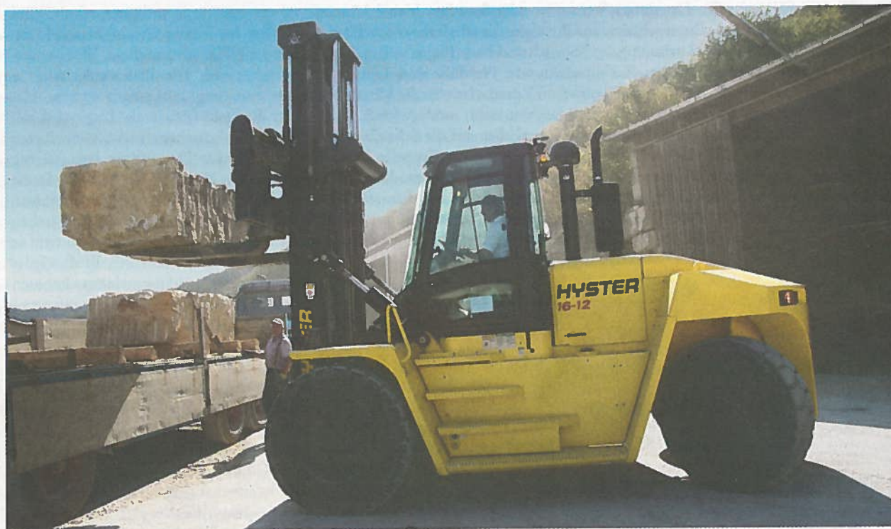
Mit seinen Gabelzinken fährt der Hyster H16.00XMS-12 in die rund 16 Tonnen schweren Blöcke rein und hebt sie hoch.
